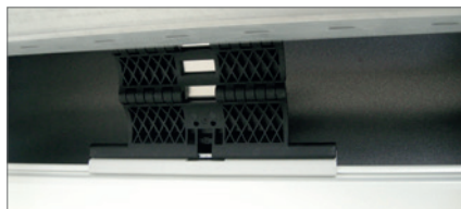
Aufschiebesicherung aus Kunststoff und Federstahl verhindert ein unbefugtes Aufschieben.
